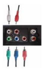
Los conectores de componentes dividen la señal de vídeo en tres señales: dos de color y una de blanco y negro. Si va a utilizar los conectores de componente, también deberá conectar los cables de sonido. Para ubicar el conector de componentes, consulte "Vista inferior" en la página 141.
